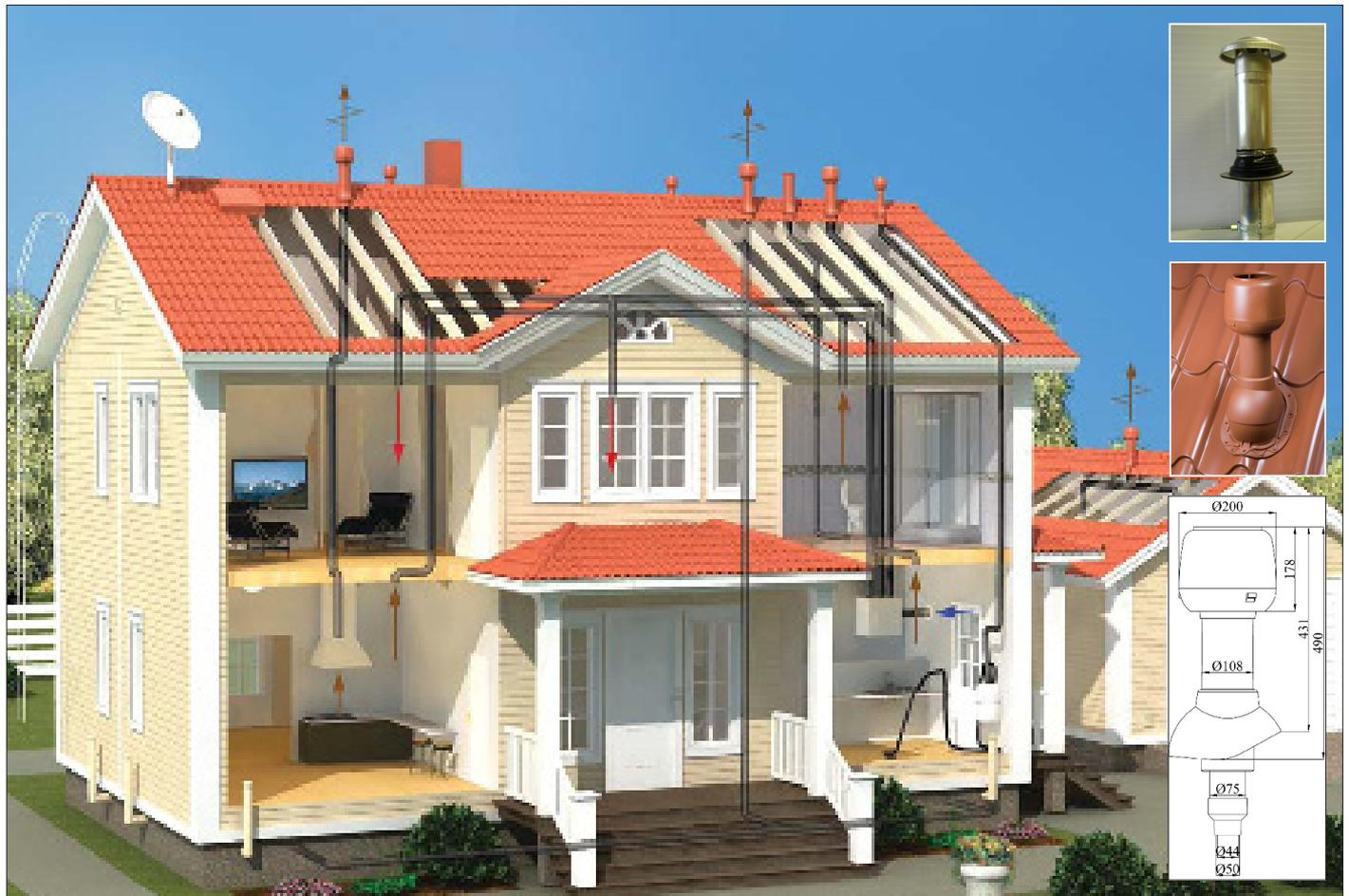
Bild 24 Dachdurchdringungen-Lüftervarianten
